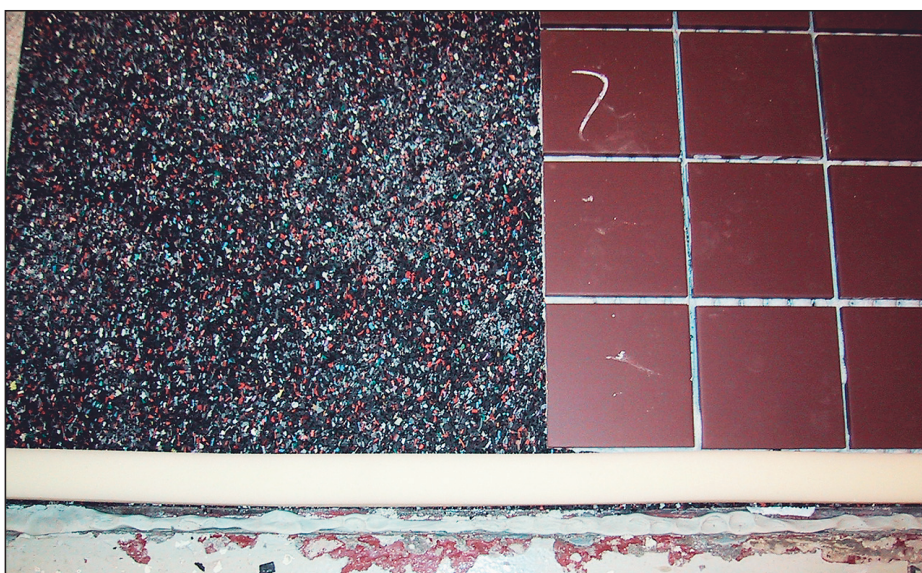
Stegljudsdämpande matta till vänster. Keramikplattor i fix till höger. SP Sveriges Provnings- och Forskningsinstitut i Borås.
